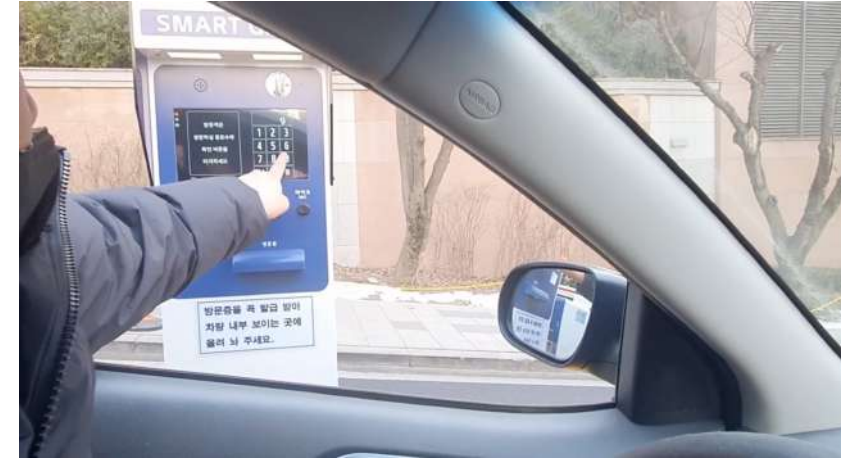
방문객이 직접 방문할 동.호수 입력 & 차량 출입이력 서버에 자동 저장 블랙리스트 등록 조건 설정에 따른 해당 방문객 차량 자동 출입제한
